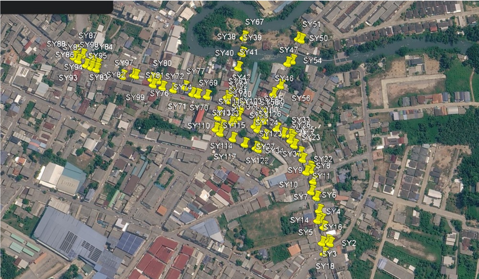
ภาพที่ 17 การระบุพิกัดการสำรวจ RTK อ้างอิงข้อมูลดาวเทียมและกรมที่ดิน (แนบไฟล์พิกัดการสำรวจ) ที่มา คณะทำงาน
